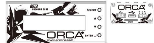
付属の4ピンワイヤー(200mm)をESC設定ポート(4ピンポート)へ接続しバッテリーにバッテリーワイヤーを接続して下さい。ESCの電源を入れると、プログラムボックスは自動で起動します。画面に“Loading...”と表示されESCの設定をプログラムボックスが読取られます。プログラミングの読み込みが終了すると画面に“ORCA R32 Pro” “Program”と表示されます。これで、ESCの設定変更の準備が整った事となります。“Enter”を押してプログラムモード、またはデータの読み込み画面に移動します。4種類のモードに分かれています。各モードは初期設定値となっています。Blinky(ノンフースト)、Modified、Open Stock Brushless、Offroad
